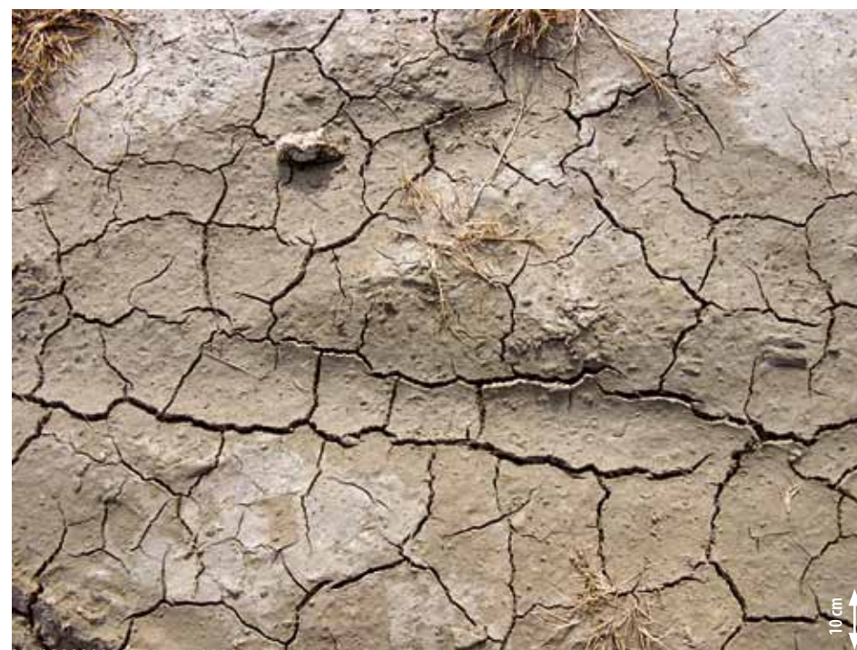
Croûte de battance développée à la surface du sol, en cours de fissuration par le dessèchement.
