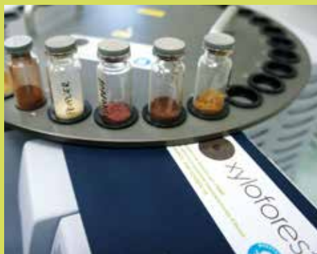
Spectromètre proche infrarouge du Plateau technique Xyloomic : échantillons d'essences de bois en attente d'analyses en vue de déterminer leurs composés. © A. Girard, Inra
